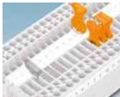
P-DI ayrırma bıçağı ile devre istendiğinde ayrılabilir. Bıçak, yerine ters takılarak kaybolması önlenir
