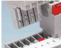
Kodlama pinleri fişlerin yanlış yere takılmasını önler
